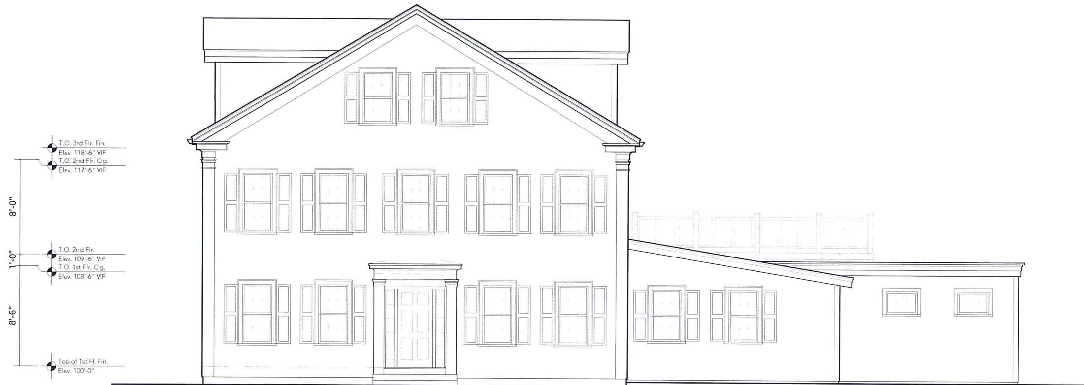
1 Front Exterior Elevation - MERRIMAC SCALE: 1/8" = 1'-0"
