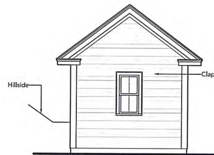
⑦ Exterior Elevation - REAR SCALE: 1/8" = 1'-0"
