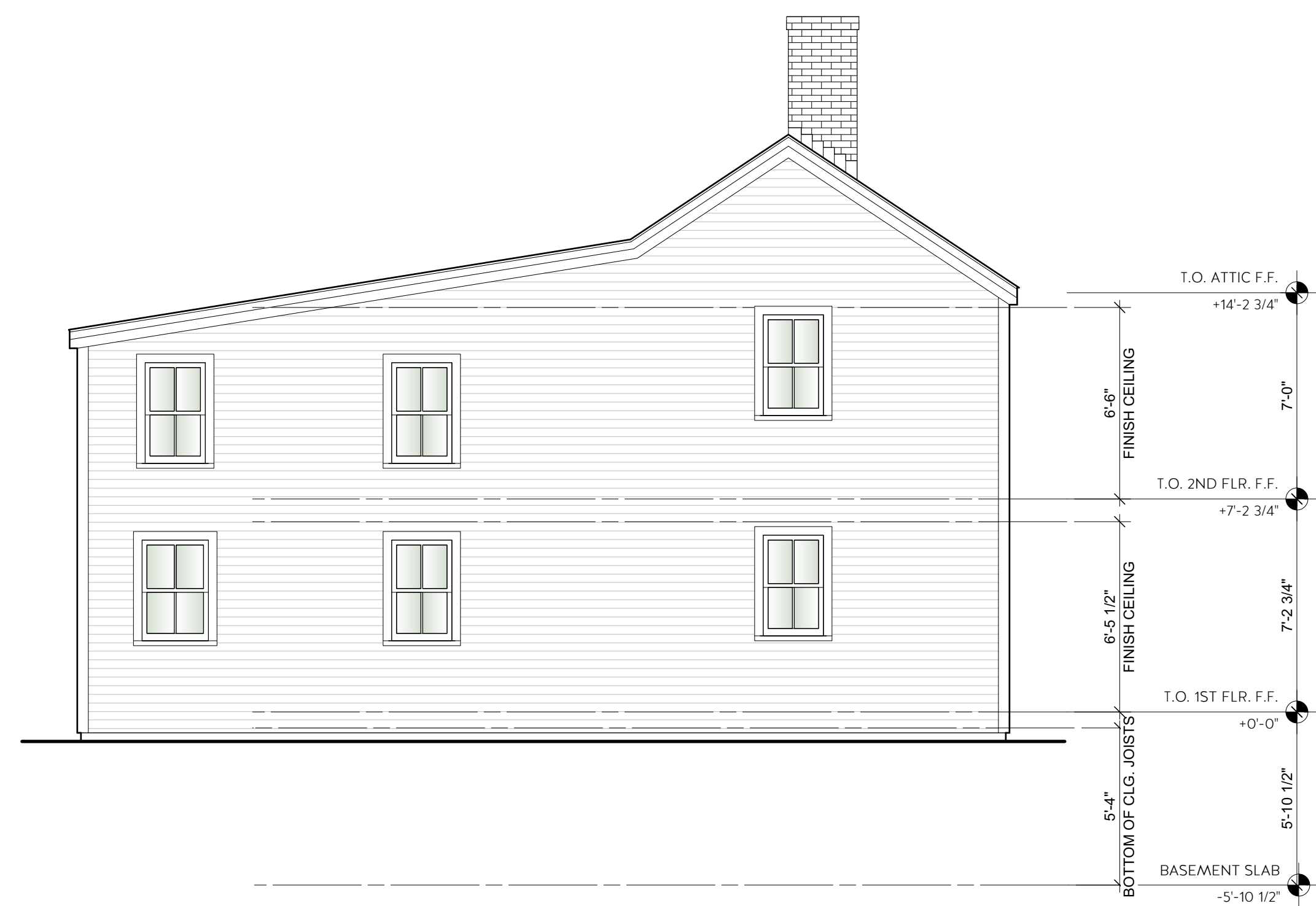
2 LEFT ELEVATION Scale: 1/4" = 1'-0"
