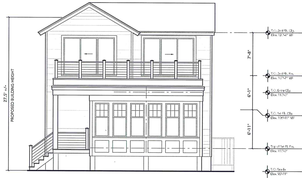
① Exterior Elevation - FRONT SCALE: 1/8" = 1'-0"
