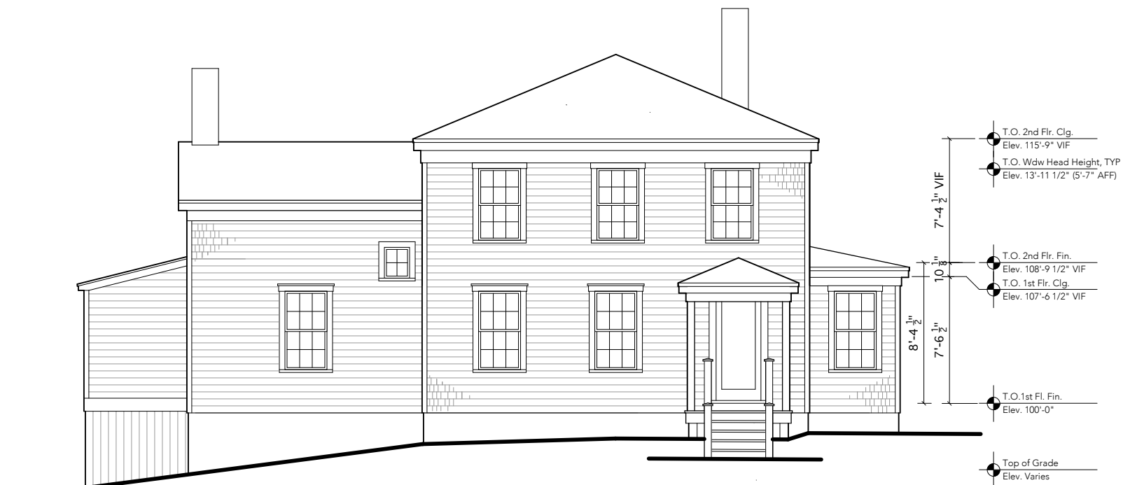
① Front Exterior Elevation - EXISTING SCALE: 1/8" = 1'-0"
