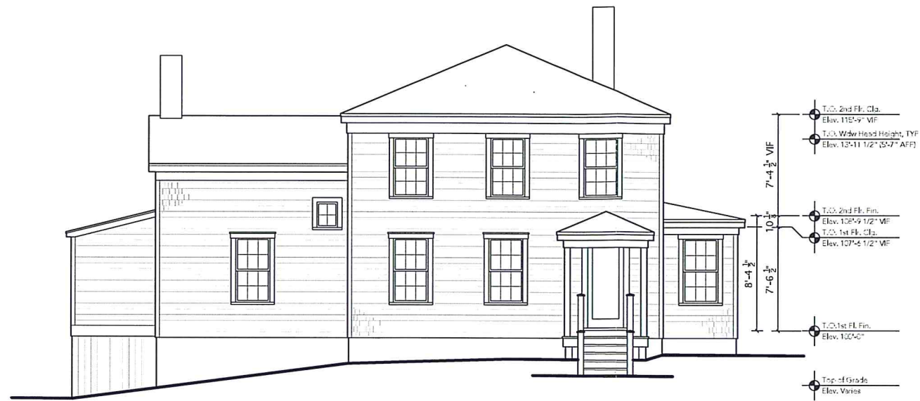
① Front Exterior Elevation - EXISTING SCALE: 1/8" = 1'-0"
