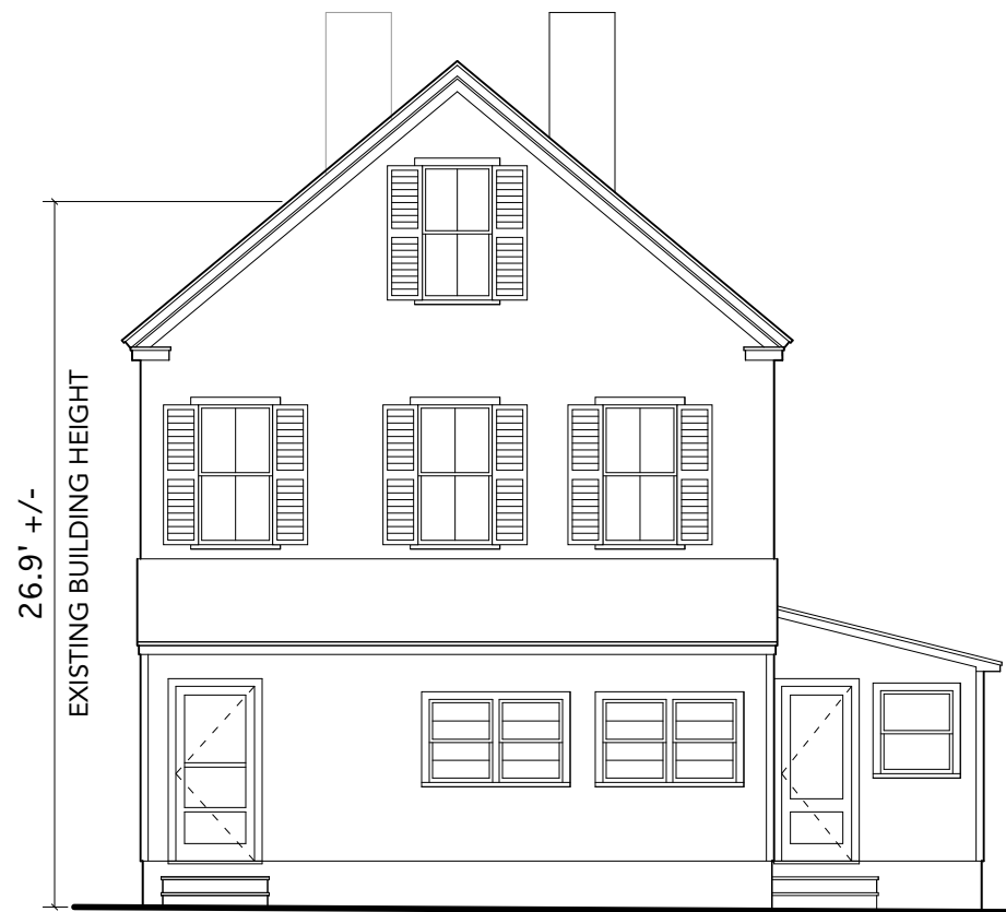
1 Front Exterior Elevation - EXISTING SCALE: 1/8" = 1'-0"
