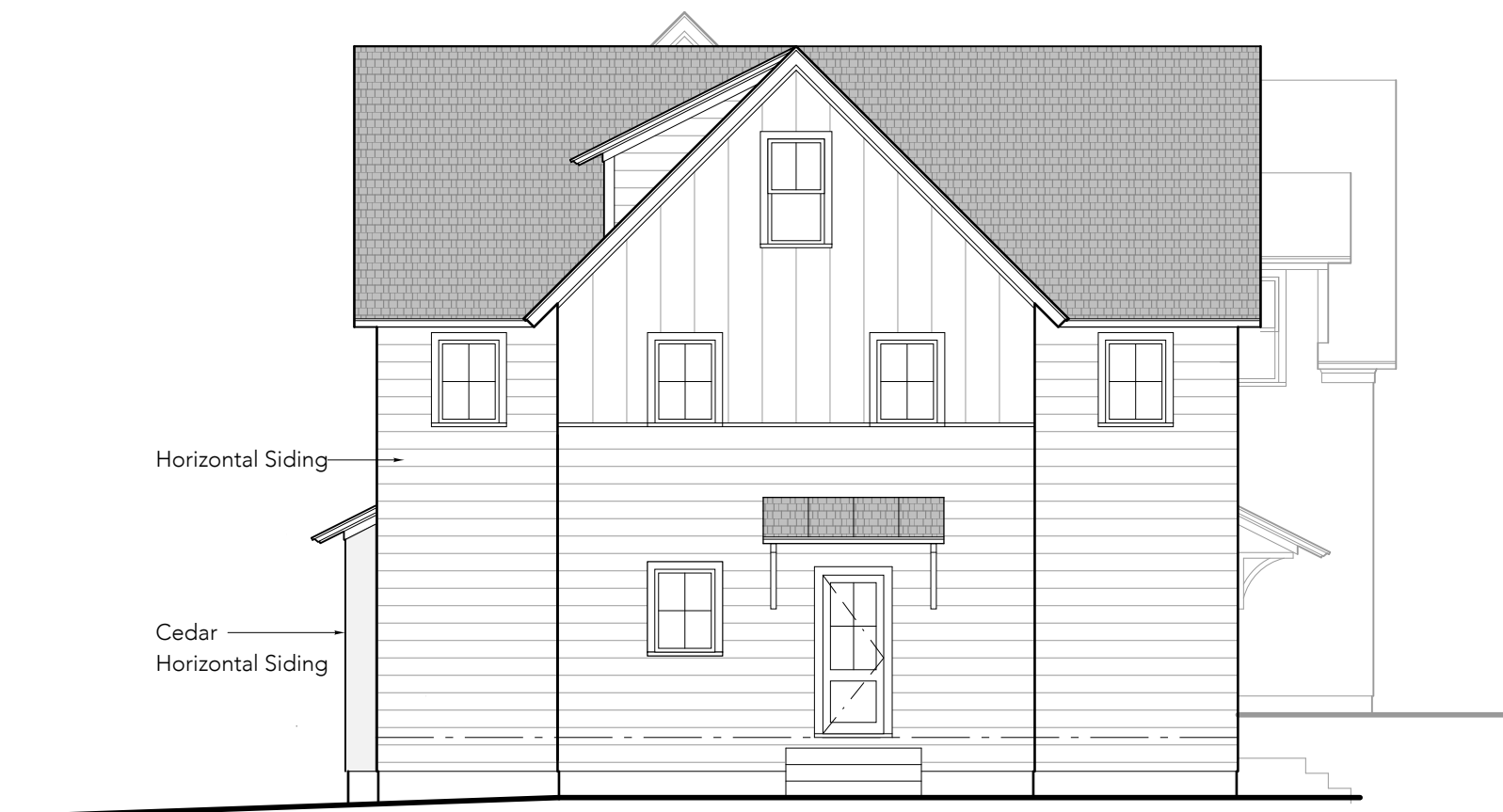
1 Exterior Elevation - REAR SCALE: 1/8" = 1'-0"
