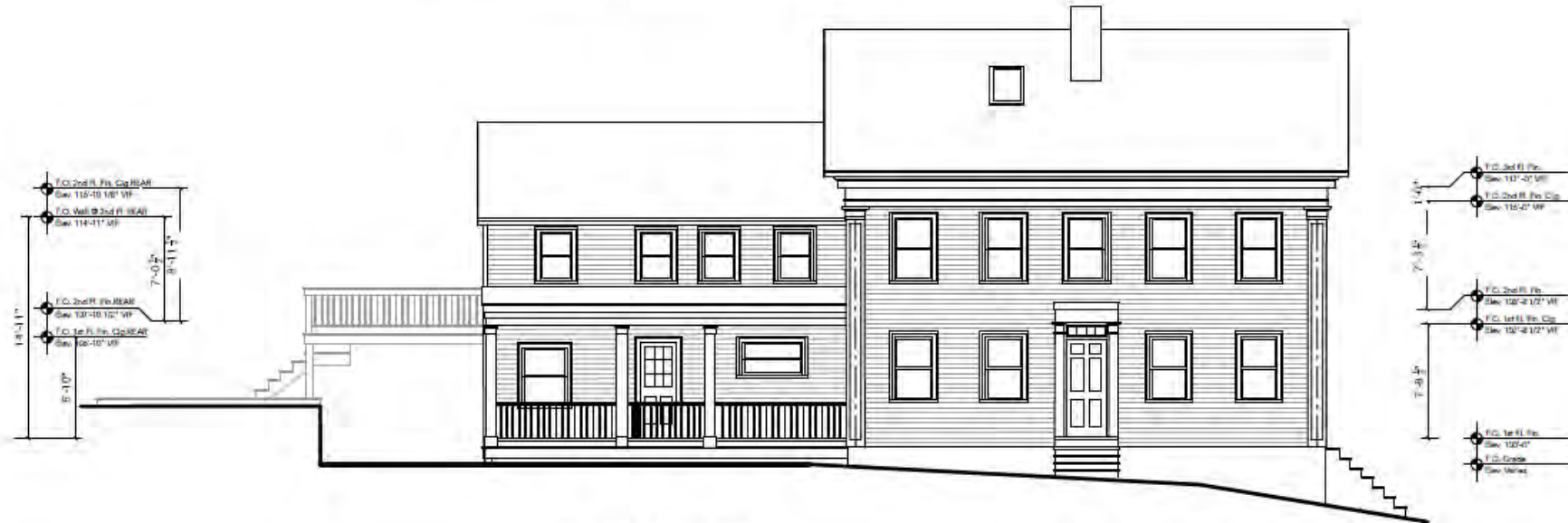
2 Exterior Elevation - SIDE SCALE: 1/8" = 1'-0"
