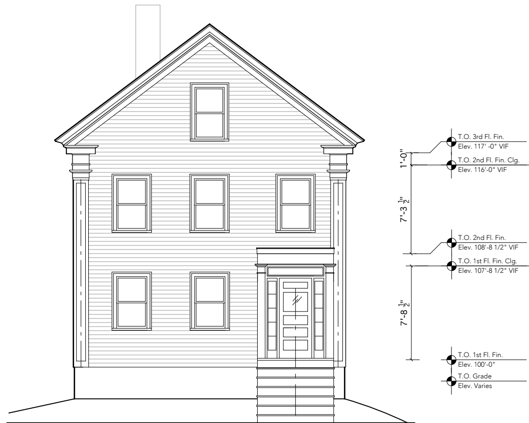
1 Exterior Elevation - FRONT SCALE: 1/8" = 1'-0"
