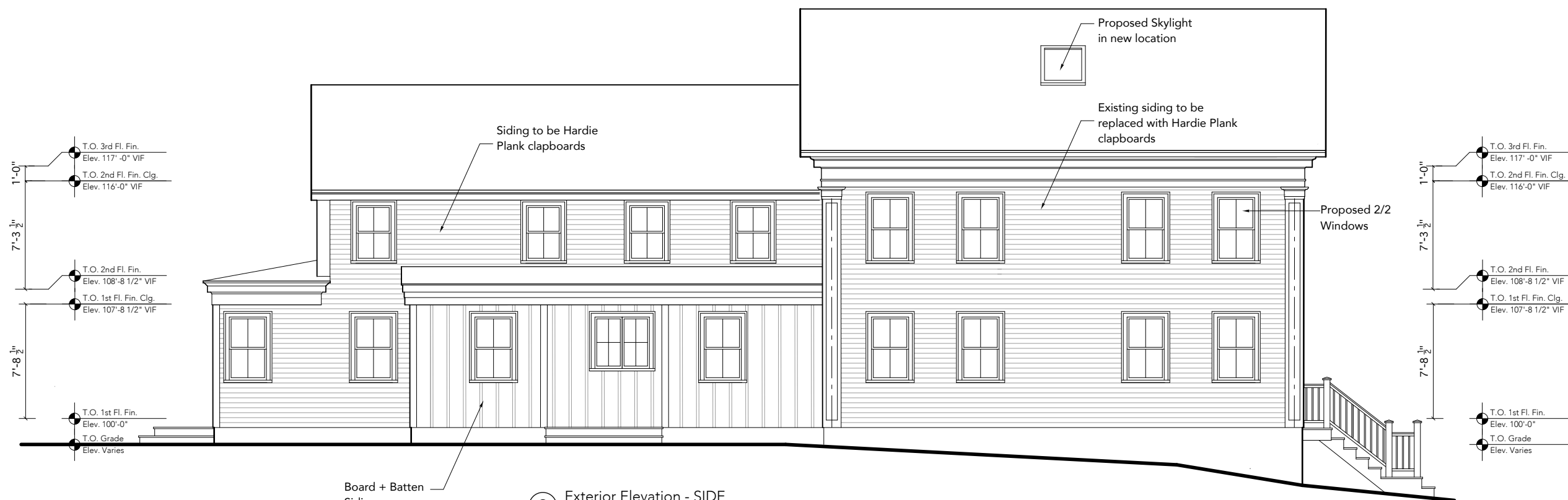
2 Exterior Elevation - SIDE SCALE: 1/8" = 1'-0"
