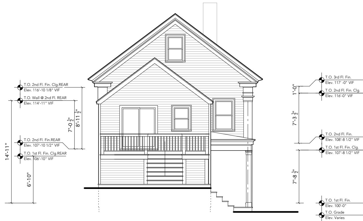
1 Exterior Elevation - REAR SCALE: 1/8" = 1'-0"
