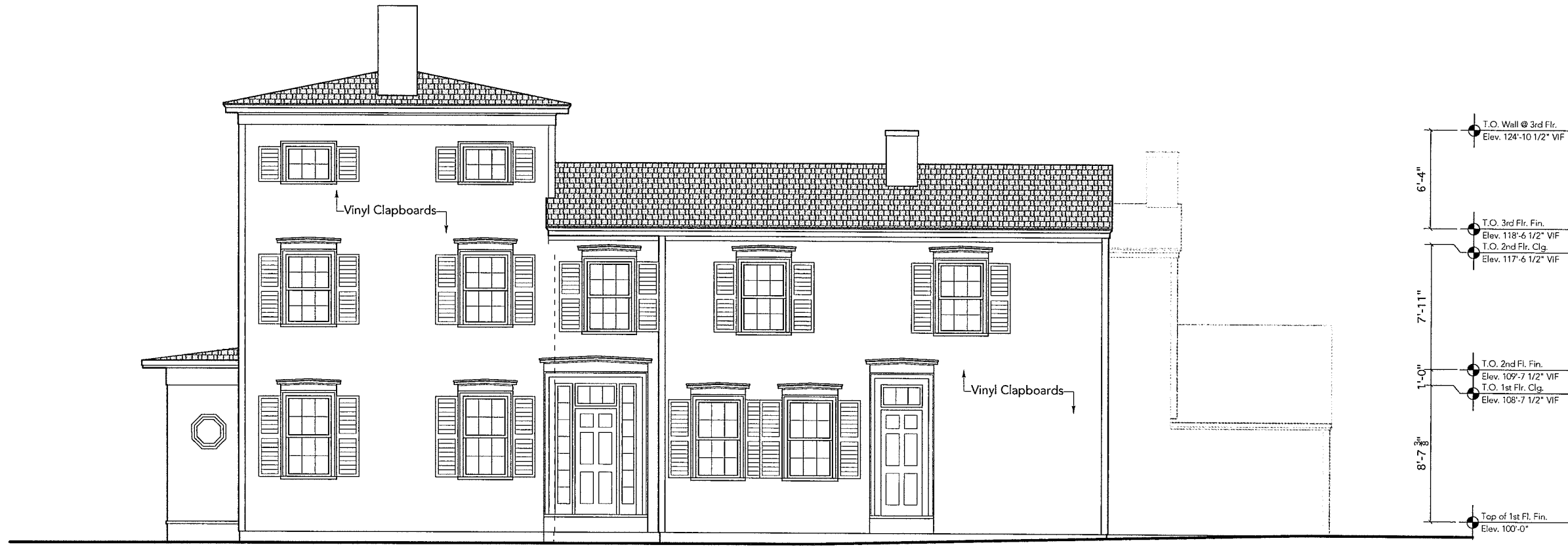
1 EXISTING Exterior Elevation - Side SCALE: 1/8" = 1'-0"
