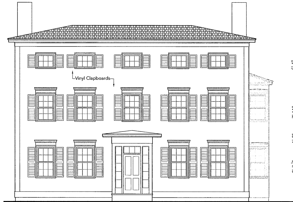
1 EXISTING Exterior Elevation - Front SCALE: 1/8" = 1'-0"
