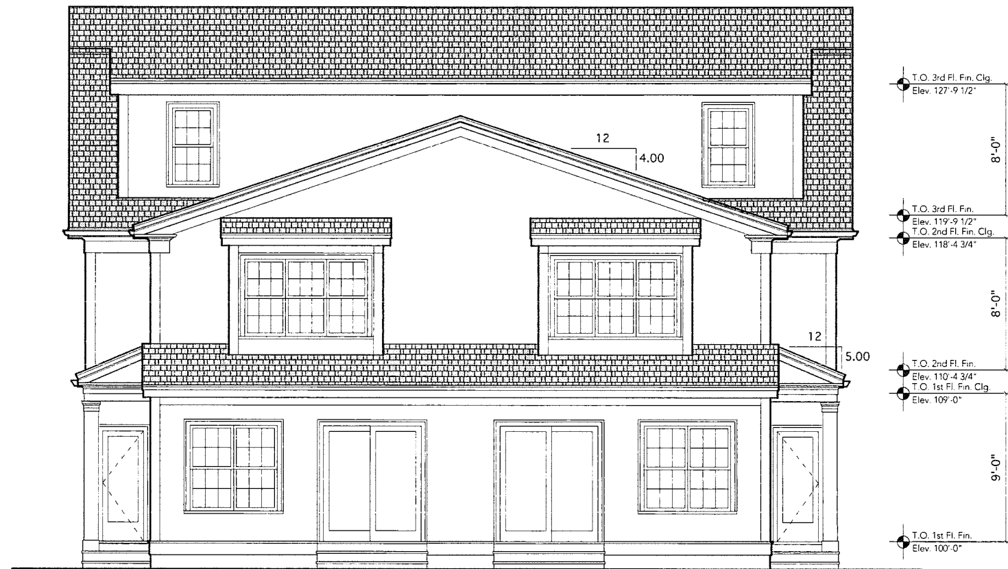
① Exterior Elevation - Rear SCALE: 1/8" = 1'-0"
